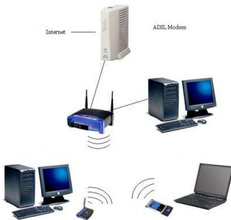
Slika 2.13. Najjednostavnija WLAN arhitektura koja se susreće u kućnoj primjeni
