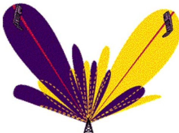
Slika 4.20. Primjer dijagrama prilagodljivoga antenskog sustava bazne postaje koja komunicira s dvije pokretne postaje
