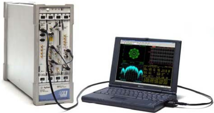
Slika 2.48. VSA se ponekad dopunjuje prijenosnim računalom čime raste sposobnost obrade mjernih podataka i njihova prikaza
