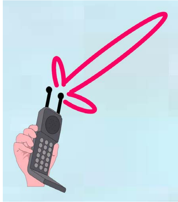
Slika 4.14. Inteligentnom antenom usmjerava se snop zračenja krajnje pokretne postaje u smjeru bazne postaje
