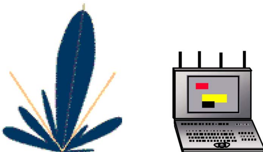
Slika 4.19. Prilagodljivi antenski sustav ima sposobnost usmjeravanja maksimuma glavnog snopa prijama u smjer željenog korisnika i usmjeravanja minimuma dijagrama prijama u smjerove iz kojih dolaze signali smetnje
