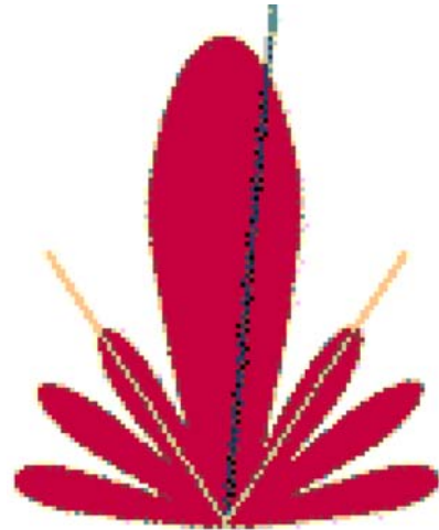
Slika 4.18. Osim što ne može podesiti maksimum glavnog snopa točno u smjer dolaska signala od pokretne postaje nema ni mogućnosti utjecaja na oblik dijagrama antene u području sekundarnih latica.
